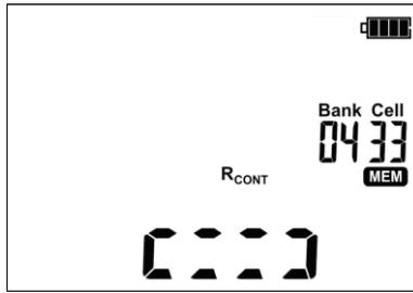
Die Zelle ist zum Teil mit einer anderen Art von Prüfergebnis belegt. – Symbole des bereits gespeicherten Ergebnisses werden angezeigt.
