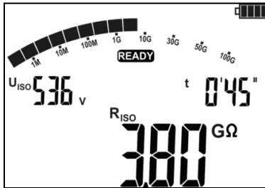
Nach Abschluss oder Abbruch der Messung, werden die Ergebnisse angezeigt. Es werden alle erzielten Messergebnisse angezeigt (sogar, wenn die Messung nach 60 Sek. unterbrochen oder abgebrochen wurde. Ging das Prüfgerät in den Standby Modus, können die Messergebnisse durch **ENTER** wieder angezeigt werden.
