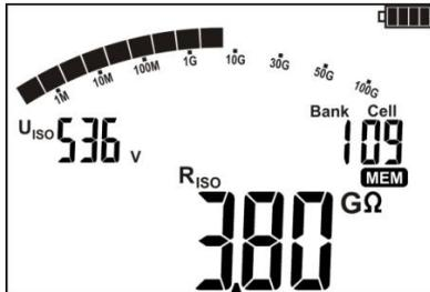
Die Zelle ist zum Teil mit derselben Art des Messergebnisses belegt, wie dass, das eingetragen werden soll.
