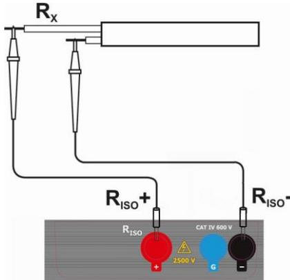
Schließen Sie die Prüflitungen entsprechend der Zeichnung an.
