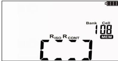
Zelle ist komplett belegt, Symbole des bereits gespeicherten Ergebnisses werden angezeigt.
