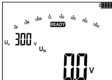
Das Prüfgerät ist zur Messung bereit.
