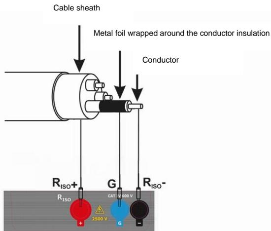
In gleicher Weise sollte dies so durchgeführt werden, wenn die Isolation zwischen zwei Leitern des Kabels gemessen wird, schließen Sie den **G** Anschluss an einen anderen Leiter, welcher nicht in die Messung mit einbezogen ist, an.
