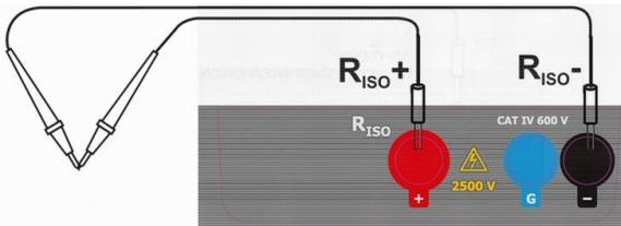
Schließen Sie die Leitungen kurz – Die Meldung **READY** wird angezeigt.
